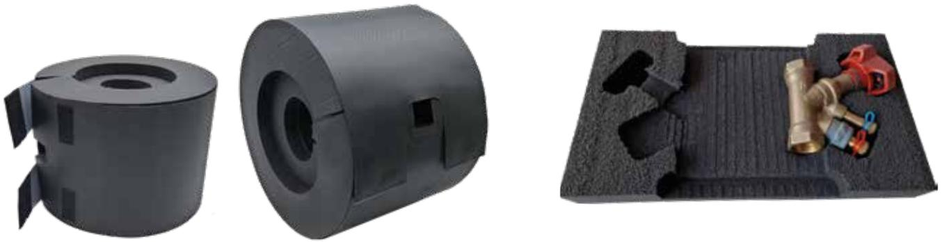
K-FLEX® K-BOX Isolierkappen werden passgenau für Armaturen, Ventile, Flansche und Kupplungen entwickelt, sodass Luftspalt zwischen Ventil und Isolierung vermieden wird. Dies ist ein großer Vorteil, insbesondere bei Wechseltemperaturen.. Die geschlossenzellige Struktur des verwendeten Premium-Isoliermaterials K-FLEX® ST kombiniert dabei hohe Dämmleistung mit einem hervorragenden Wasserdampfdiffusionswiderstand.
