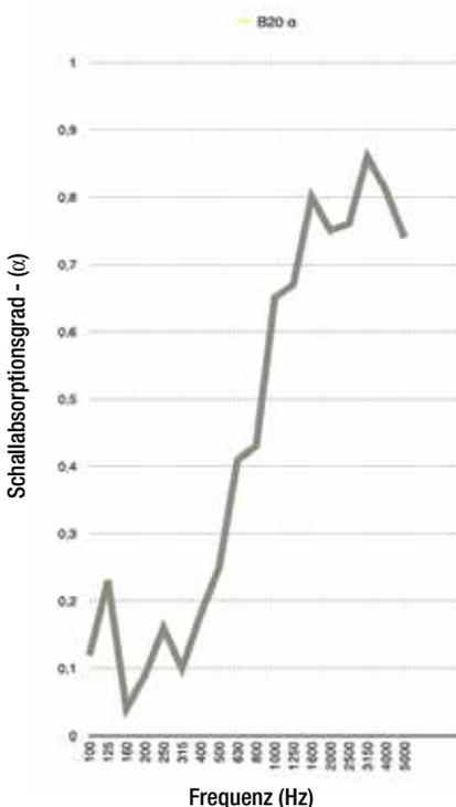
K-FLEX® K-FONIK B 20 (Dämmdicke: 20 mm)
