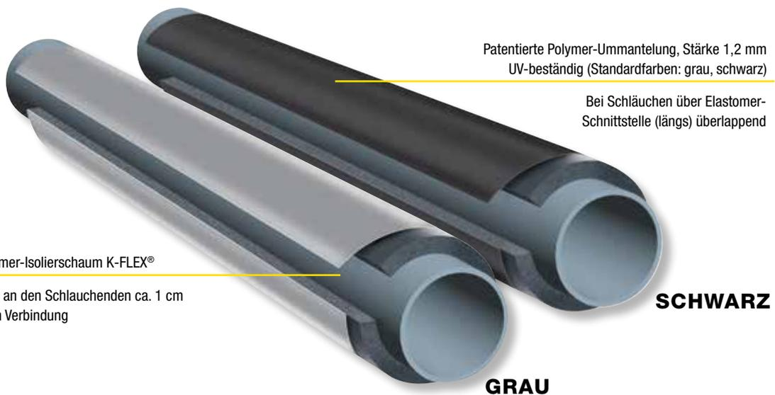
Geschlossenzelliger Elastomer-Isolierschaumstoff K-FLEX® kombiniert mit einer 1 mm dicken, flexiblen äußeren Polymer-Ummantelung. K-FLEX® IN CLAD ist seewasserfest sowie UV- und witterungsbeständig.
