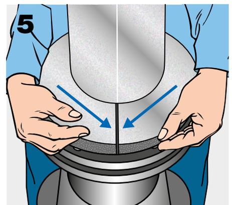
Kleben Sie anschließend die innere Kante der Ringe an den Elastomerschläuchen fest.
