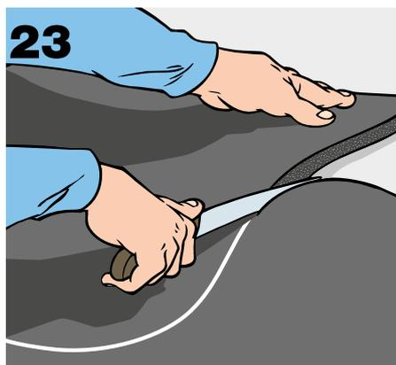
Fasen Sie die Kanten der oberen konvexen Kurven zur Innenfläche der Platte hin ab.
