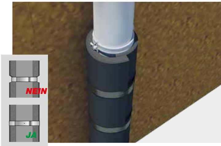
Zur dauerhaften Fixierung bei Stoß- und Überlappungsverarbeitung geeigneten Bindedraht, Singnodebänder oder Kabelbinder verwenden (6-8 Stück/m).
