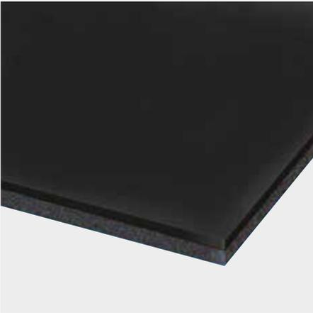
K-FLEX® K-FONIK ST GK ist die werkseitige Kombination aus dem weichen, thermisch dämmenden premium Elastomer-Dämmstoff K-FLEX® ST mit der hocheffizienten, schallisolierenden Schwerfolie K-FLEX® K-FONIK GK und stellt ein wirksames Feder-Masse-System dar. Die ideale Lösung für thermo-akustische Isolierung.
