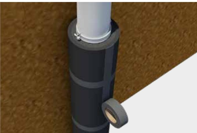
Beim Einsatz zur Tauwasserdämmung sind alle Nähte mit K-FLEX® K420 Kleber zu verkleben. Stoßkanten und Überlappungsnähte mit geeignetem K-FLEX® Klebeband abdecken.
