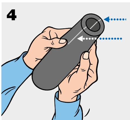
Man kürzt den Schlauch auf der schmalen Seite auf die Größe der kleineren Rohrdimension.
