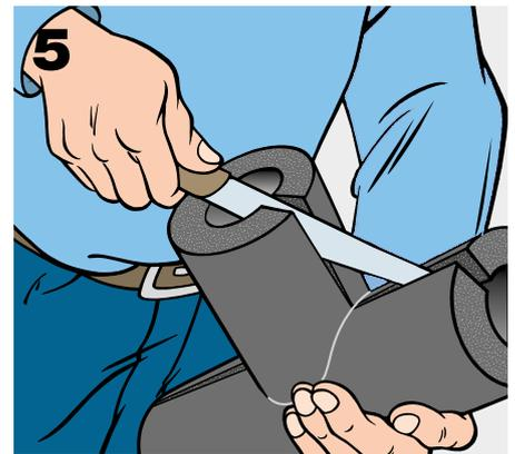
Das kürzere Schlauchstück wird am Endstück von der Mittellinie ausgehend zu einem Winkel von jeweils 45° geschnitten.
