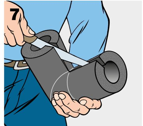
Das Auftragen des Klebers kann nach Belieben vor oder nach der Positionierung auf dem Rohr erfolgen.
