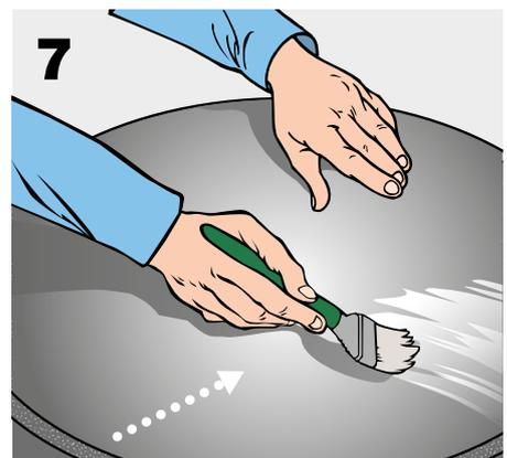
Dann verklebt man die Platte mit dem Behälterdeckel, indem man sie von der Mitte bis zum Rand leicht andrückt, um eine Blasenbildung zu vermeiden. Ebenso wird der Behälterboden isoliert.
