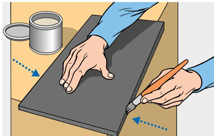
Mit Hilfe einer Fingerprobe wird kontrolliert, ob der aufgetragene Klebstoff ausreichend abgelüftet ist.
