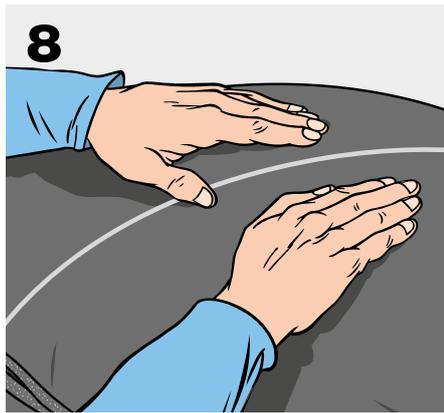
Sind die Platten perfekt auf die Oberfläche angepasst, bestreicht man die äußeren Seiten der Isolierung des Behälterkopfes und des Zylinders mit dem K-FLEX® Kleber.
