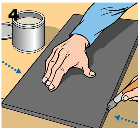
Nun legt man die Platte um das Rohr und klebt die beiden äußeren Enden aneinander.
