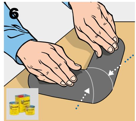
Nach dem Ablüften des Klebers kann der Winkel an der Innenseite längs geschlitzt werden.
