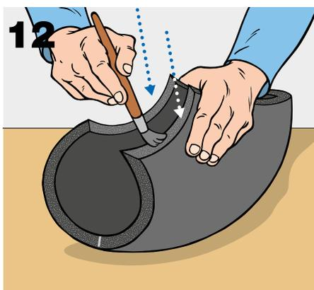
Nun kann der Bogen auf das Rohr montiert werden, die Schnittflächen werden fest aneinandergeklebt.
