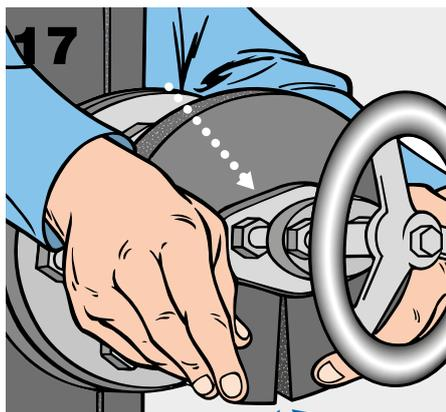
Der Umfang der oben montierten Stirnscheibe ist ebenfalls mit gleichem Material zu ermitteln.
