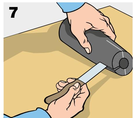
Nun kann das Reduzierstück an der Längsnaht und mit den Stößen der angrenzenden Schläuche verklebt werden.
