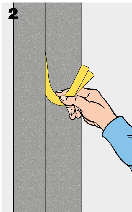
Bei den verklebten Nähten ist darauf zu achten, dass sie nicht dauerhaft unter Spannung sind. Bei horizontaler Verlegung sollte die Naht nicht auf 12 Uhr liegen.
