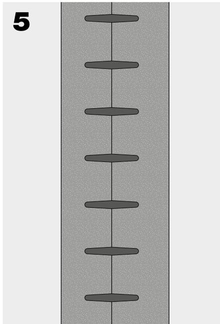
Eines der abgeschnittenen Stücke des K-FLEX® PE Schlauches auf die Rohrleitung auflegen, andrücken und mit der selbstklebenden Lasche verschließen. Drehen Sie das zweite Schnitt-Teil um 180° und legen Sie es auf die gleiche Weise wie das vorherige, sodass die beiden einen rechten Winkel bilden.
