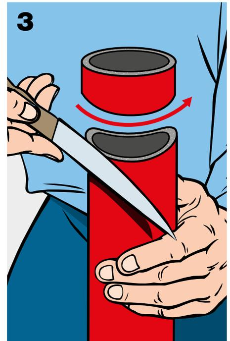
Schneiden Sie den Schlauch der Länge nach auf, schieben Sie ihn über das Rohr und positionieren Sie ihn so, dass er mit dem Abgang des Rohres übereinstimmt. Danach kann die Schnittstelle verklebt werden.
