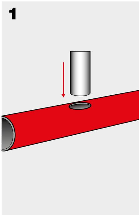
Für die Herstellung des Abzweigs schneiden Sie einen Halbkreis aus der Isolierung. Bitte vom Körper weg schneiden.
