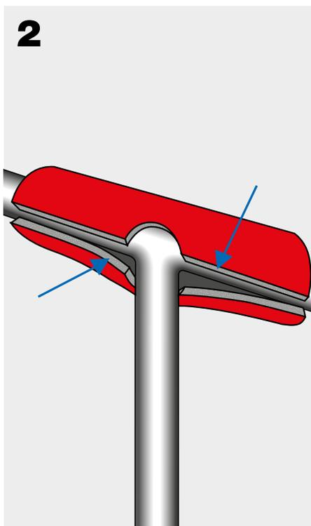
Richten Sie beide Zuschnitte so aus, dass sie formschlüssig ineinander passen und verkleben Sie das ganze mit K-FLEX® GEWEBEKLEBEBAND.
