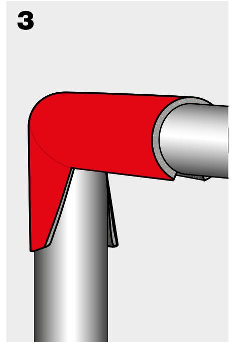
Drehen Sie einen der Schlauch-Zuschnitte, bis er mit dem anderen einen 90° Winkel bildet.
