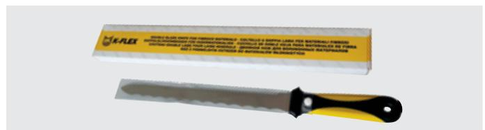
Messer für faserige Materialien, doppelseitiger Wellenschliff für verschiedene Arten und Dichten von Mineralwolle: Bügelsägeblatt für Platten und Schläuche mit hoher Dichte, und klassische Messerklinge für Schläuche, Rollen und leichte Platten. Ergonomischer Griff für Rutschfestigkeit und Griffigkeit, Klingenlänge 280 mm.
