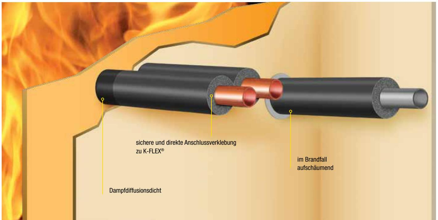
**K-FLEX® R90** ist als Schlauchware erhältlich. Die geschlossene elastomere Zellstruktur ist kombiniert mit Blähgraphit, der im Brandfall eine intumeszierende Wirkung hat. Die verschiedenen Stärken (19 und 25 mm) leisten einen Beitrag zur thermischen Dämmung.
