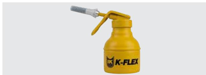
Praktisches Werkzeug mit regulierbarer Pumpe und Pinsel für das einfache und gleichmäßige Auftragen des Klebers auf K-FLEX® Schläuche und Platten. Zweckmäßigerweise wird der Behälter mit verdünntem Kleber befüllt, der durch eine manuell betätigte Pumpe zum Pinsel gefördert wird. Das Werkzeug ist nach Gebrauch sorgfältig mit dem K-FLEX® Spezialreiniger zu reinigen.
